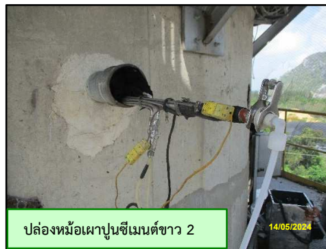
ภาพที่ 3.2 การตรวจวัด TSP และ \text{SO}_2 จากปล่องหม้อเผาปูนซีเมนต์ขาว 1 และ 2
