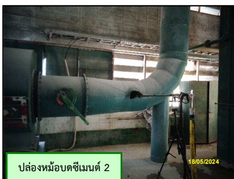
ภาพที่ 3.4 การตรวจวัด TSP จากปล่องหม้อบดซีเมนต์ 1 และ 2
