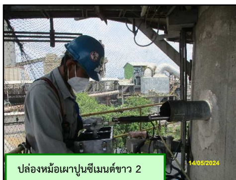
ภาพที่ 3.3 การตรวจวัด \text{NO}_x as \text{NO}_2 จากปล่องหม้อเผาปูนซีเมนต์ขาว 1 และ 2
