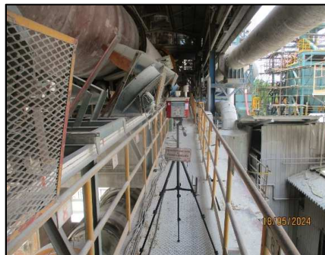
ภาพที่ 3.52 การตรวจวัดระดับความร้อนบริเวณ ทางเดินข้างแท่น 3 หม้อเผา 2
