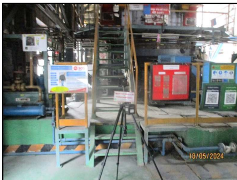
ภาพที่ 3.57 การตรวจวัดฝุ่นละอองในสถานที่ทำงานบริเวณหม้ออบด Pet Coke
